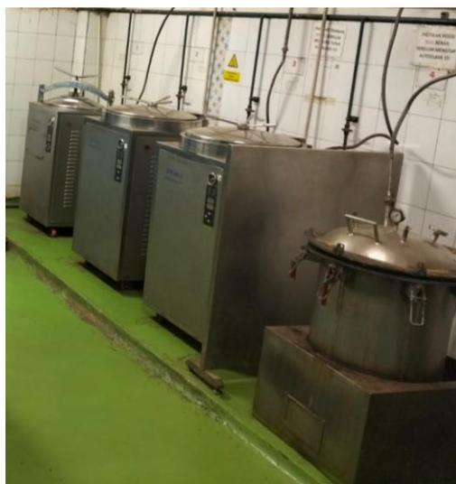
**Gambar 3.6 Mesin *Autoclave***
