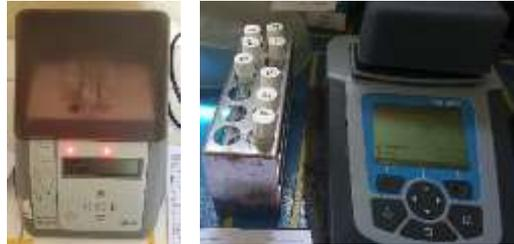
**Gambar 3.21** Pengujian COD pada Air Limbah
