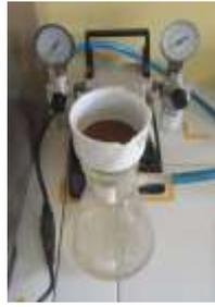
**Gambar 3.22** Pengujian TSS pada Air Limbah
