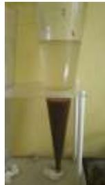
**Gambar 3.23** Analisis *Sludge* Volume pada Air Limbah
