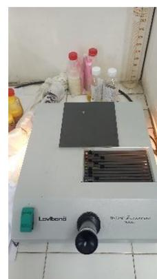
Ukur dengan alat Lovibond dengan mengeser standar warna hingga warna nampak sama
