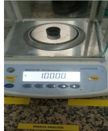
Timbang sampel yang sudah digiling 1 gr
