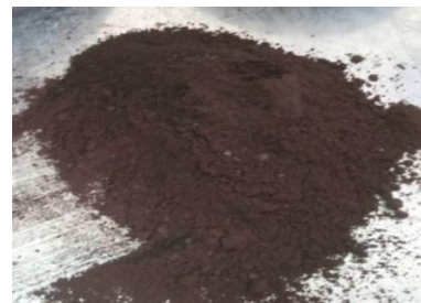
Hasil pengilingan pulverizer
