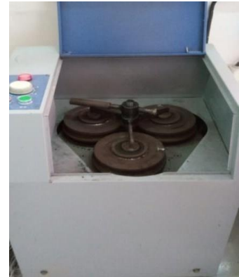
Pulverizer dihidupkan samp el batubara dari jaw cru sherdimas ukan
