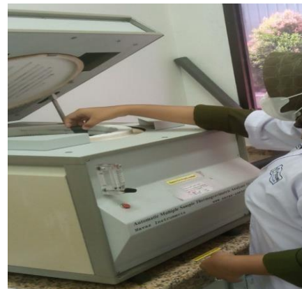
Masukkan cawan sampel ke dalam alat
